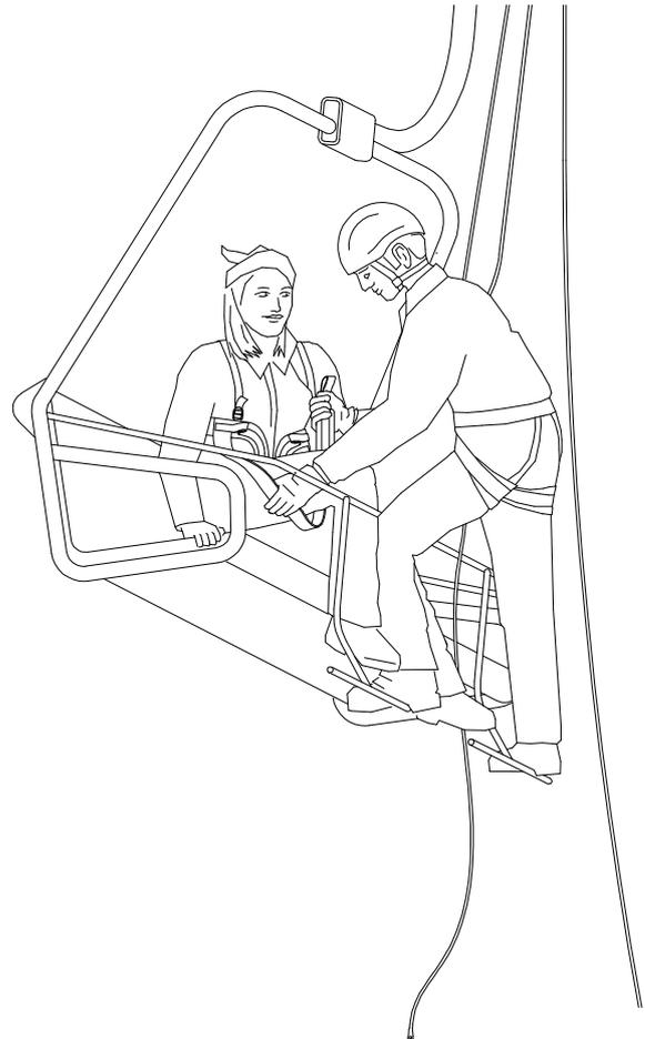
Das Abseilseil unter dem Schliessbügel durchziehen und am Bergungsgurt befestigen.
