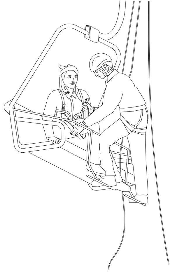
Das Abseilseil unter dem Schliessbügel durchziehen und am Bergungsdreieck befestigen.
