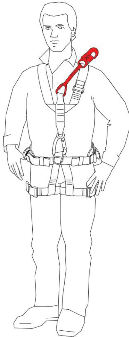
Befestigen der Verbindungsschlinge an den dafür gekennzeichneten Ösen.
