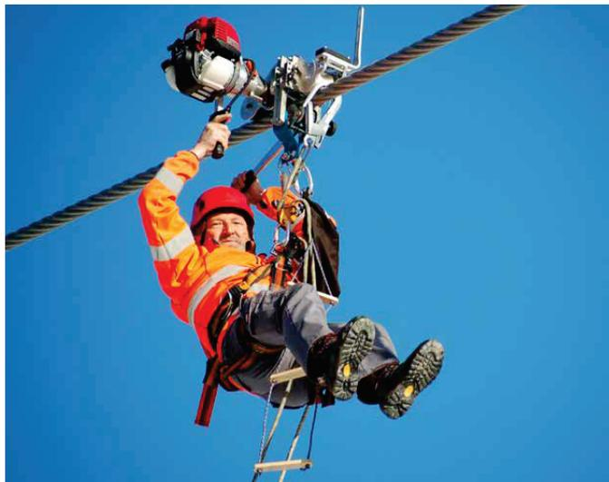
Die Seilfahrgeräte von Immoos können mit einem Motor auch bergwärts angetrieben werden.
